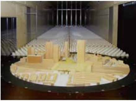
Foto 2. Opstelling windtunnelonderzoek TNO.
