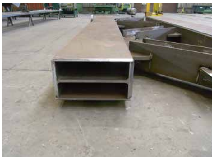
Foto 1. Links: met flankplaten 'verkoerde' doorsnede onderrand spant. Rechts: de capaciteitsvergroting is alleen gedaan in de zwaarst belaste zones.
